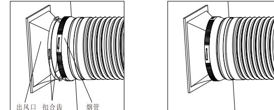
接公共烟道侧：按图所示，先行在公共烟道上开孔安装止回阀后（止回阀风叶可打开侧朝向公共烟道内），将烟管套入止回阀并使用烟管喉箍固定即可。
