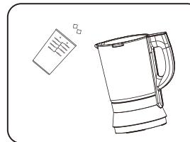
5、杯盖两侧扣耳错开对齐杯口凸耳，把杯盖压入搅拌杯，再将杯盖顺时针旋转与杯体扣好，最后将加料盖压紧在杯盖上。(杯体有开盖保护装置，如杯盖未旋盖到位，产品将不通电)
